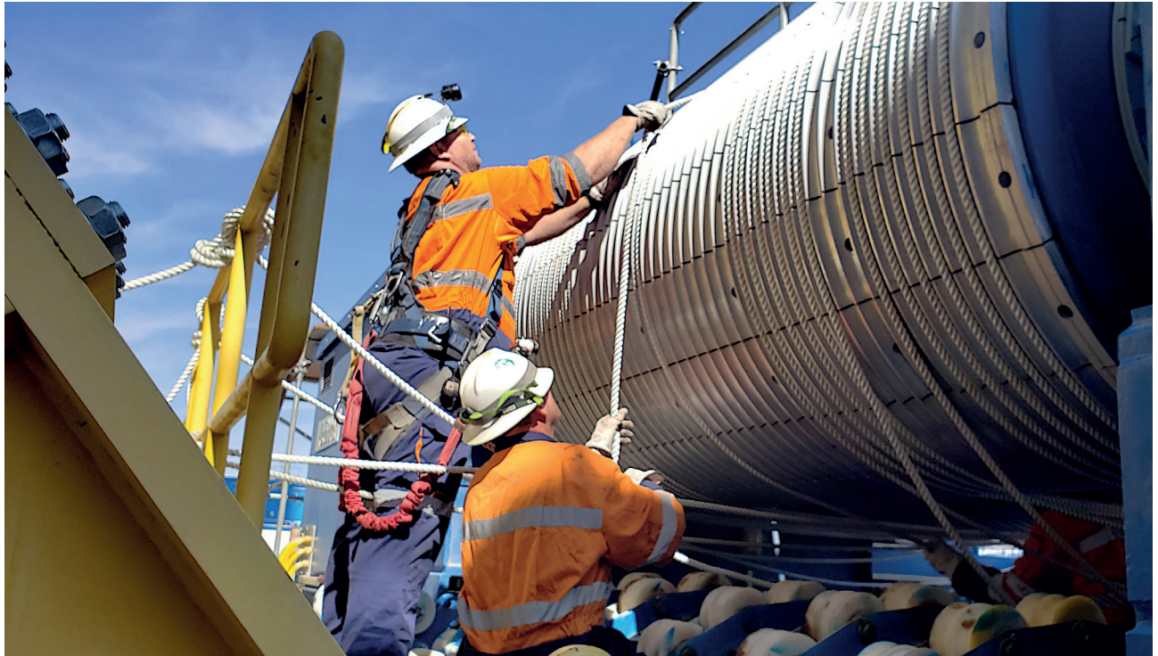
服务团队的员工在移动换绳绞车上工作。
