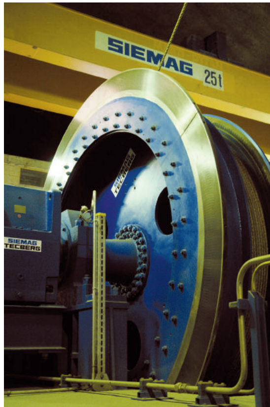
Bild 7: Einseiltrommel-Förderhaspel der mittleren Seilfahrtanlage
