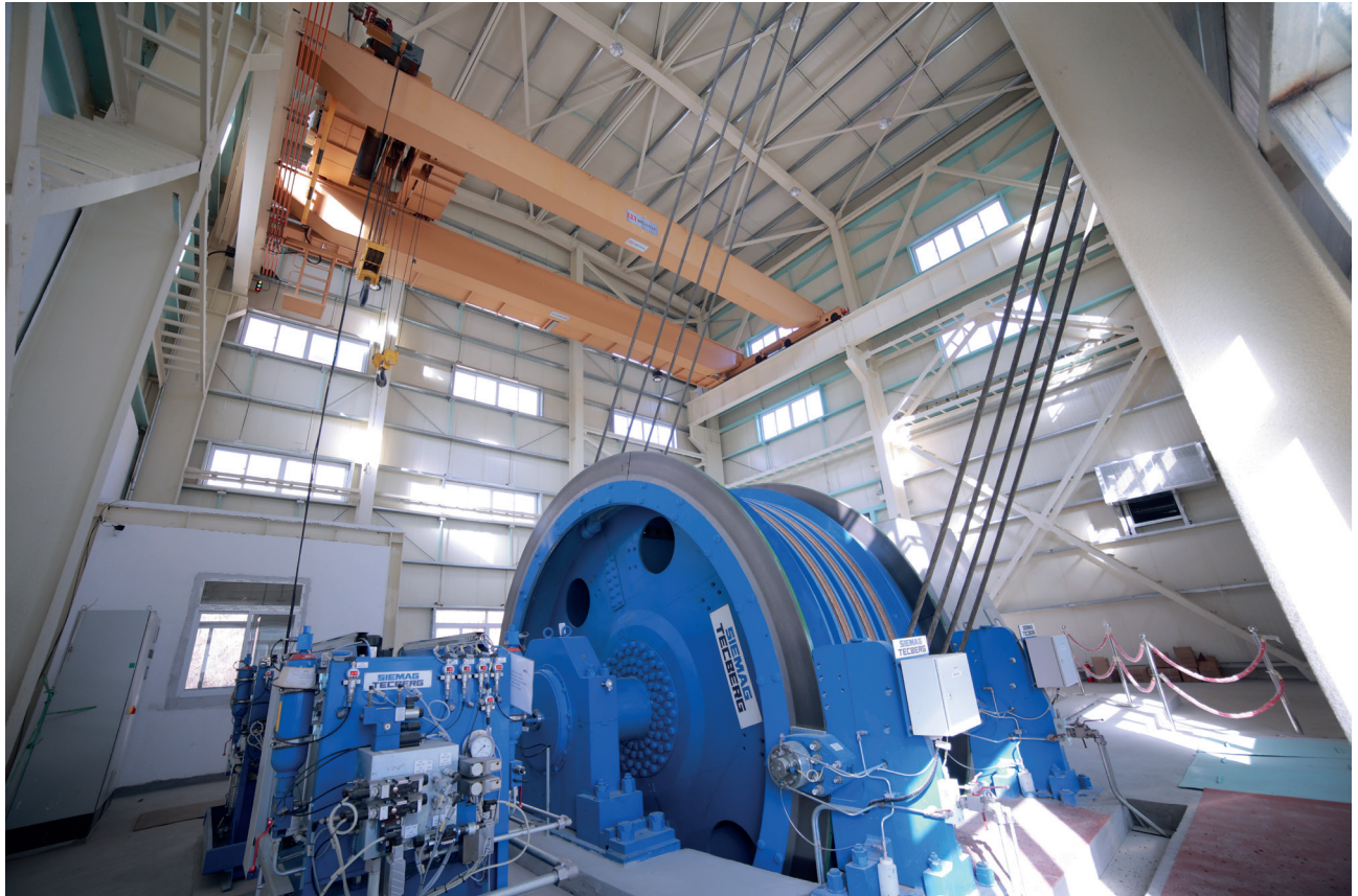
图2：副井的四绳摩擦式提升机也在运行中。
