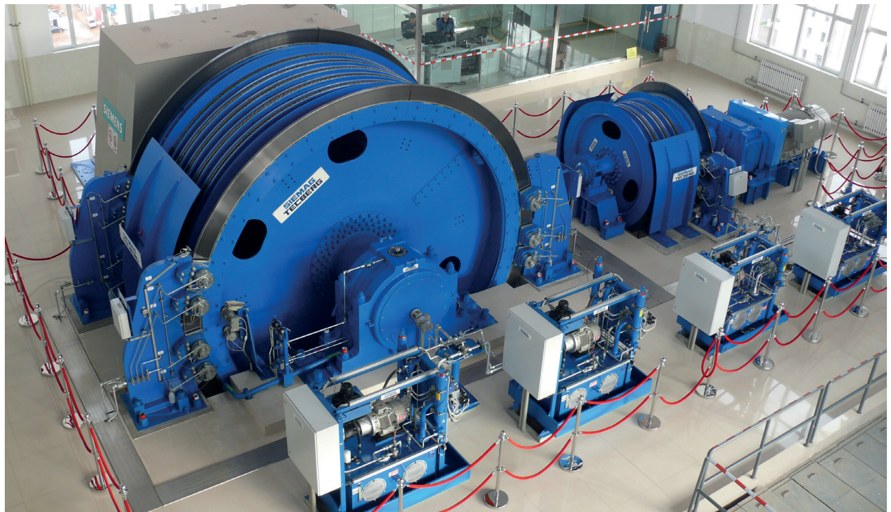
Abb. 2: Referenzbild SIEMAG TECBERG 6-Seil Koepemaschine in Turmanordnung. Copyright 2022 Tianjin SIEMAG TECBERG.
