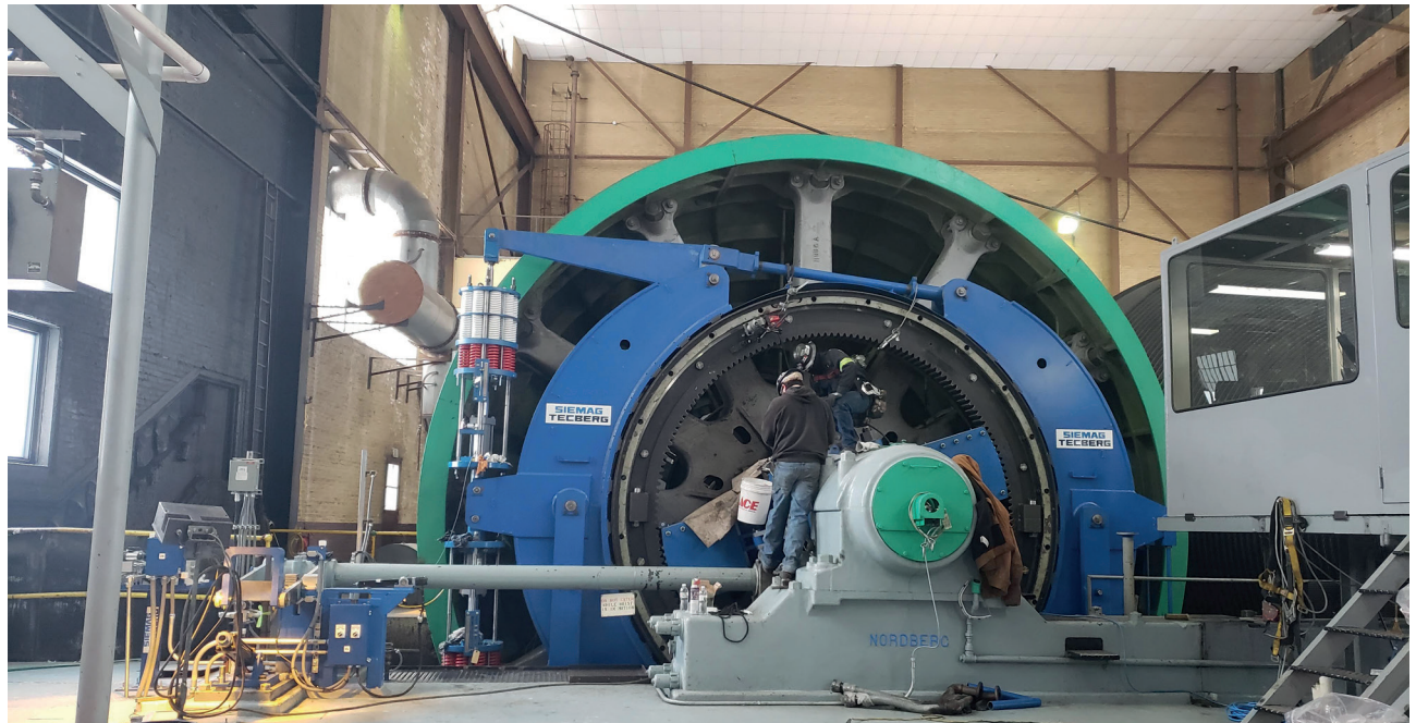
Rys. 5: Widok maszyny bębnowej z napędem linowym z nowym sprzęgłem i nowym układem hamulcowym.
