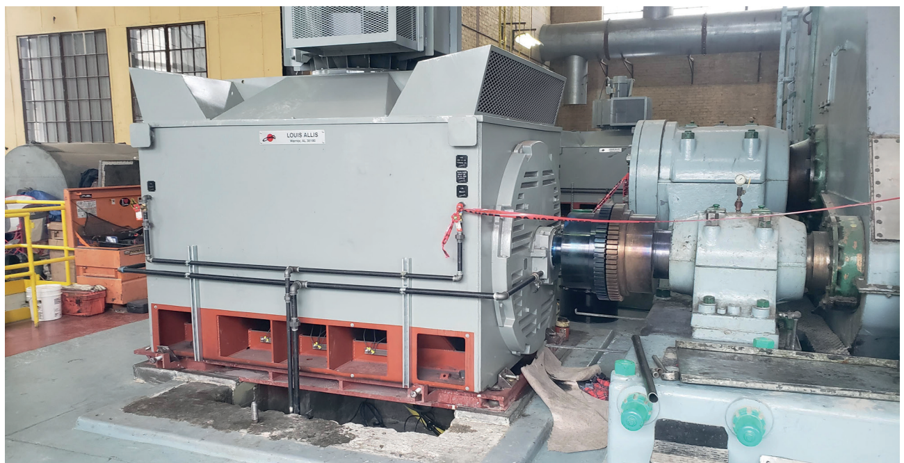
Rys. 6: Nowy silnik prądu zmiennego dla maszyny wyciągowej z napędem linowym
