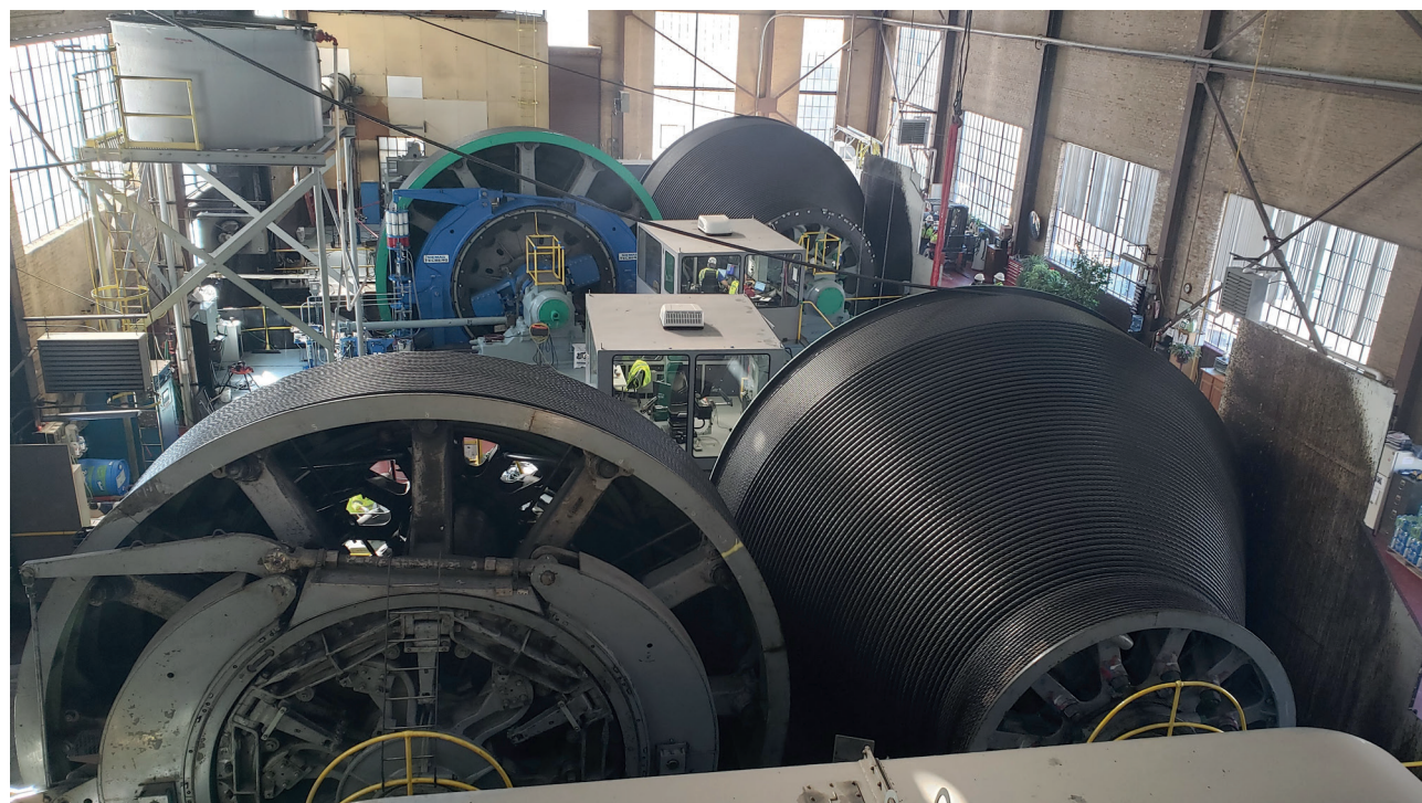
Рис. 4: вид машинного зала шахты Росс с обеими барабанными подъёмными машинами: на переднем плане - оба барабана скиповой машины, на заднем плане - барабаны машины для людского подъёма, между ними - оба пульта управления в кабинах машиниста
