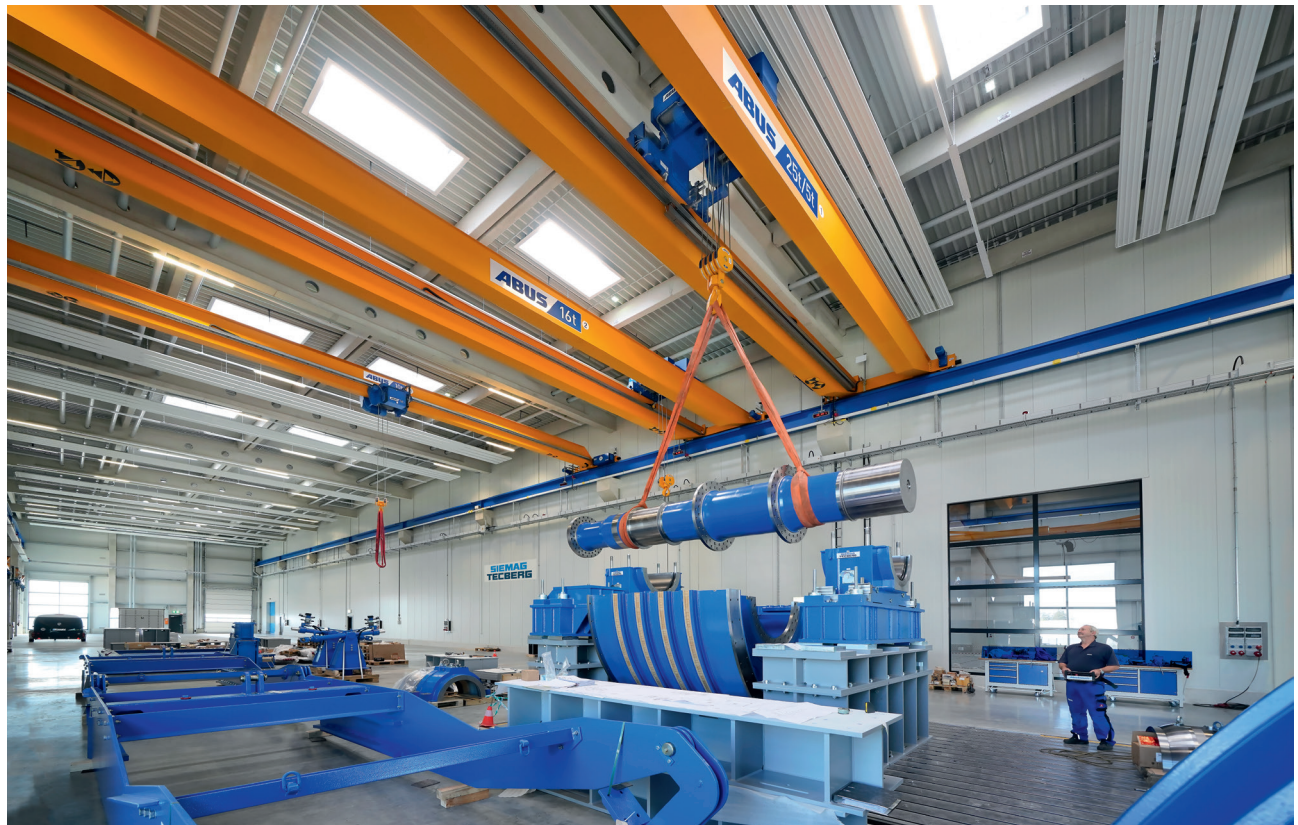
Aufbau einer Koepe-Fördermaschine auf dem Schwerlastprüffeld in der neuen Produktmontagehalle III der SIEMAG TECBERG.
