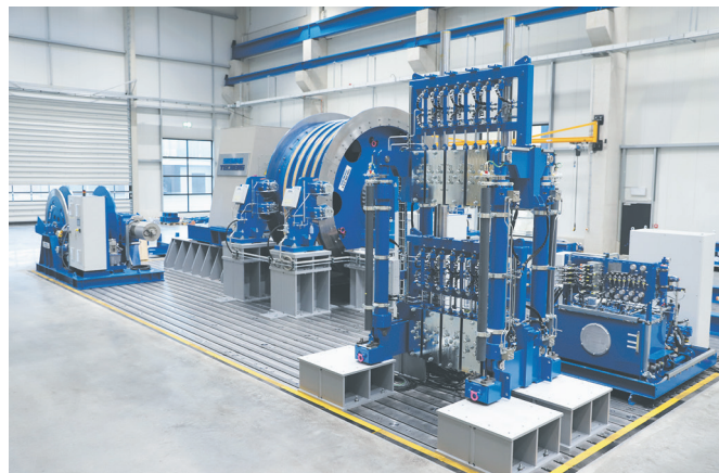
Высококачественная продукция SIEMAG TECBERG проходит комплексные стендовые испытания в целях обеспечения безупречного взаимодействия механических и гидравлических узлов оборудования, а также средств автоматизации и приводной техники
